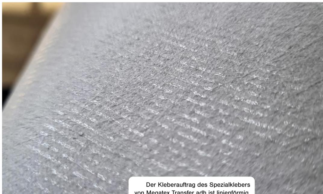
Der Kleberauftrag des Spezialklebers von Megatex Transfer adh ist linienförmig.
